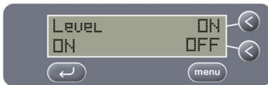
El sensor de nivel es un dispositivo resistivo, por lo que no detecta líquidos con muy poca conductividad, como el agua pura desionizada (DI). El sensor de nivel puede desactivarse para aplicaciones de limpieza especiales en las que se utiliza agua desionizada. Utilice las teclas ACTIVAR y DESACTIVAR para configurar la función de sensor de nivel de líquido. Una vez seleccionada la opción que deseé, utilice la tecla MENU para pasar a la pantalla siguiente.
