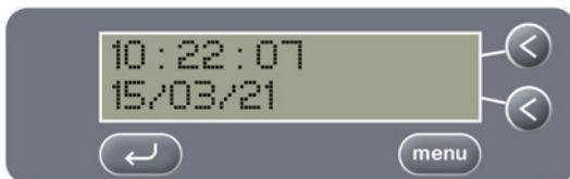
Si desea cambiar la fecha y la hora, pulse la tecla MENU para desplazarse por las opciones y utilice las teclas ARRIBA y ABAJO para efectuar los cambios. Una vez seleccionados los valores correctos, utilice la tecla MENU para pasar a la pantalla siguiente.
