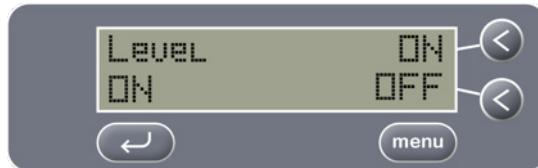
Il sensore di livello è uno strumento resistivo che non è in grado di rilevare i liquidi con bassissimo livello di conduttività, come l'acqua deionizzata pura (DI), e che quindi può essere disabilitato per le applicazioni specifiche di lavaggio che richiedono l'uso di acqua deionizzata.
