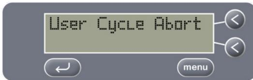
Si el sensor de nivel está activado y durante el funcionamiento la cantidad de líquido desciende por debajo del nivel necesario, el ciclo de limpieza se detiene y aparece la pantalla siguiente.
