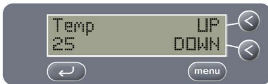
Utilice las teclas ARRIBA y ABAJO para ajustar con precisión la temperatura del líquido de limpieza entre ambientale y 70°C (160°F)
