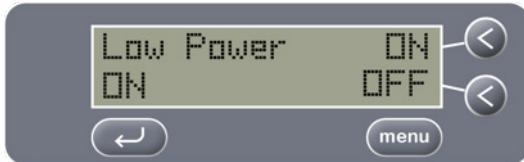
Si se activa el ahorro de energía, a los cinco minutos de inactividad el baño entra en modo de espera (SLEEP): la iluminación del visor se atenúa y el calentador de agua interno deja de funcionar.
