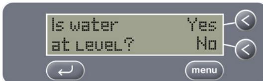
Cuando se desactiva el sensor de nivel, la temperatura del líquido establecida se reduce automáticamente a 5°C (40°F). La temperatura establecida se puede aumentar en el sistema de MENÚ (consulte la página 9).
