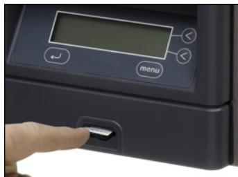
Si guarda la información en una tarjeta MC y la transfiere a un ordenador, podrá mantener un registro electrónico permanente de los parámetros de los ciclos de limpieza.
