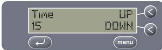
Una vez seleccionada la duración de ciclo correcta, utilice la tecla MENU para pasar a la pantalla siguiente. Este ajuste se conservará hasta que lo vuelva a modificar en el menú del operador.
