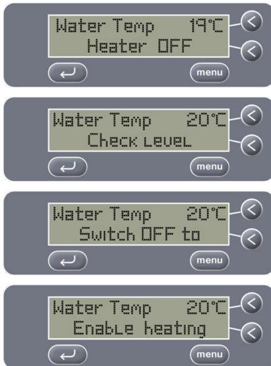
Para continuar utilizando el baño de ultrasonido digital de Grant, rellene con líquido hasta el sensor de nivel de líquido, y apague y vuelva a encender la unidad.
