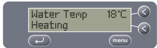
Cuando la temperatura del agua es igual o superior a la temperatura ajustada, aparece el mensaje "Temp OK" (Temperatura correcta).
